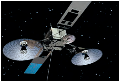
衛星 - 如追蹤及資料中繼衛星 (TDRS) - 具有大型天線和太陽能電池板，進入軌道後即可進行部署。 © Boeing。保留所有權利。
