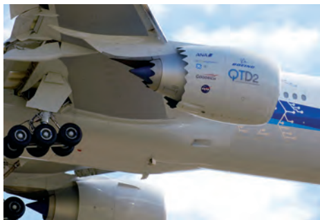
針對這架全日空航空 777-300ER 進行的測試顯示，引擎噴嘴的 V 字形形狀有助於降低噪音。 © Boeing。保留所有權利。
