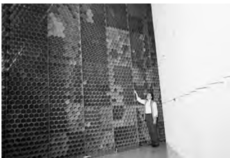
這個蜂巢設施源自於 1960 年的波音公司跨音速風洞。 © Boeing。保留所有權利。
